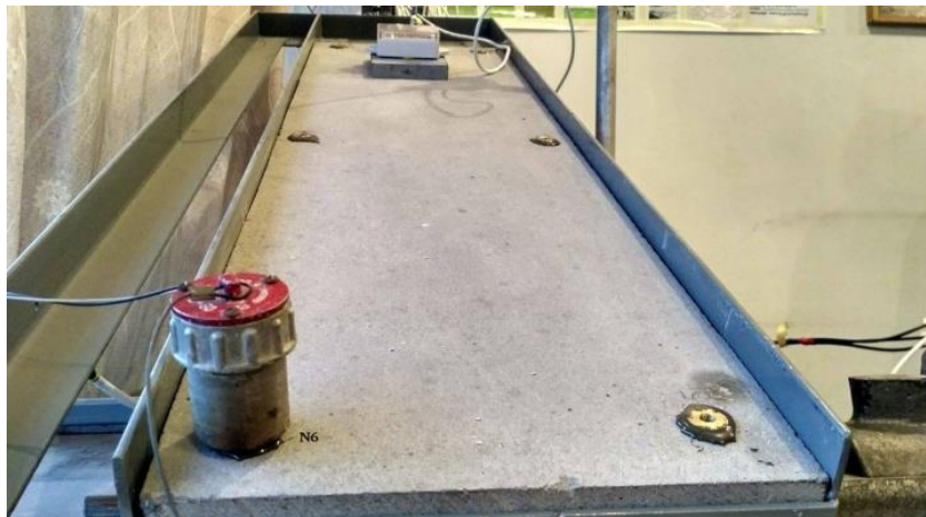
სურ.6. სამაგრი წერტილები ბაზალტის ფილაზე (მარცხენაზე დამაგრებულია დაბალსიხშირული სეისმომომღები)
