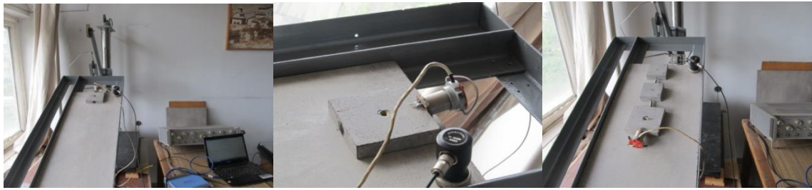
სურ.9. ბურიჯ-კნოპოვის ექსპერიმენტების გრავიტაციული ძალის გავლენის პირობებში ერთ-ერთ მოსრიალე ფილაზე მიმაგრებულია სეისმური ვიბრატორი.
