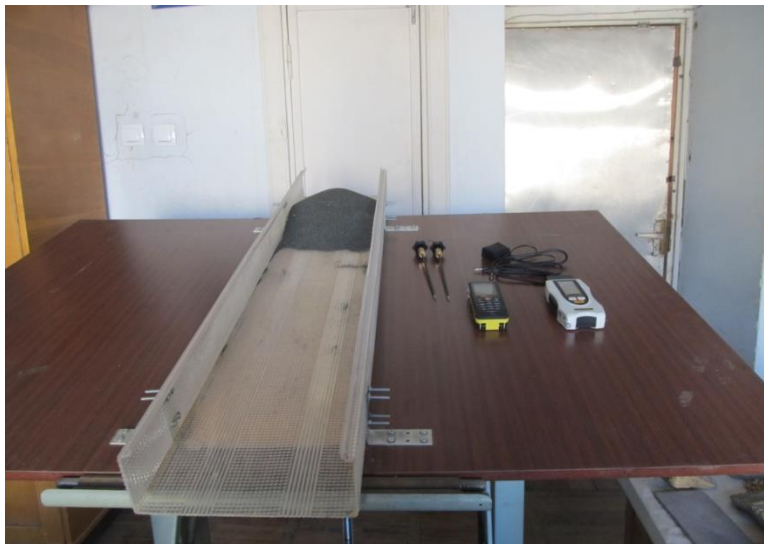
სურ.7. დანადგარი დახრის ცვლადი კუთხის მქონე დახრილ ზედაპირზე ფხვიერი მასალების გადაადგილების შესასწავლად.
