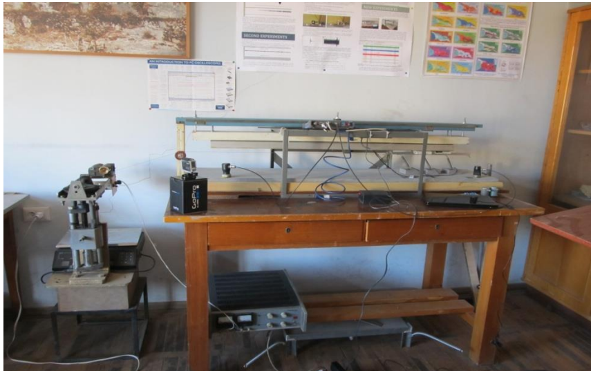
სურ.1. დანადგარი ბაზალტის ფილაზე ნიმუშების ჰორიზონტალური გადაადგილების შესასწავლად
